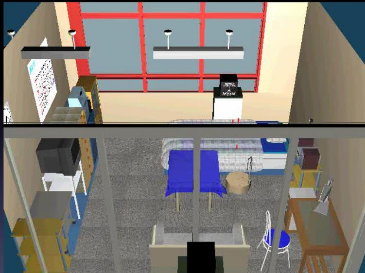
床に分布させた圧力センサや家電の利用状況のセンサなどの協調で、例えば、戸棚の近くに床圧分布があり、戸棚扉スイッチに変化があれば、人が立っていて手を伸ばして戸棚の扉を開けた・閉めたと判断
